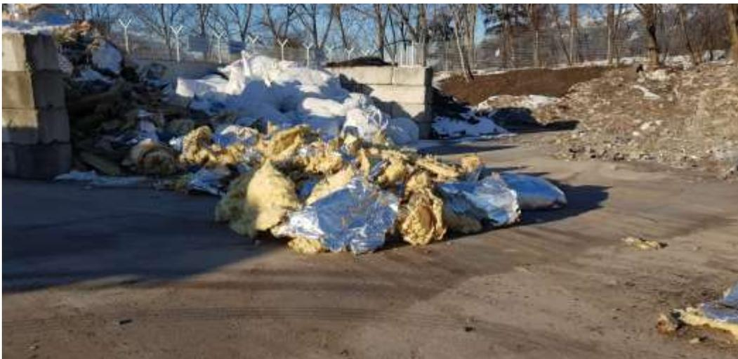
Künstliche Mineralfasern, die vor 2002 in der EU produziert wurden, sind als gefährlicher Abfall deklariert worden (Asbestabfälle). Neuere Chargen aus der EU werden als nicht gefährlich eingestuft. Dazu muss aber ein Nachweis über die Neuheit erbracht werden.
