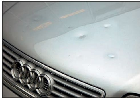
... und sorgten für Schäden: 149 Einschläge stellte der Karoseriespengler an diesem Audi fest.
