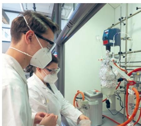
Im Bild zu sehen ist der Reaktor, in dem die chemische Synthese des Biokunststoff PLA erfolgt und der von den Schülerinnen und Schülern aufgebaut und bedient wird.
